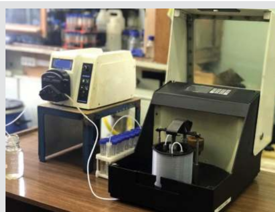
Планетарная центрифуга для разделения растворимых компонентов во вращающейся спиральной колонке
